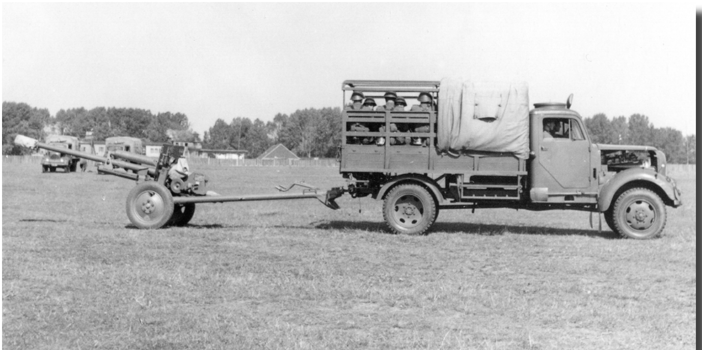
▲ Die Artilleriebatterie, in den hier abgebildeten Fotos vermutlich aus dem Jahre 1957, verfügte über drei Züge mit je zwei 76 mm Geschützen und dazu entsprechende Zugfahrzeuge. Hier der Kleinlastkraftwagen vom Typ Robur Granit 30 K mit Planenaufbau –zivile Ausführung ohne Allrad-Antrieb.
