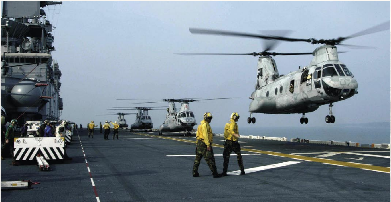
Ein Einweiser überwacht den Start einer CH-46E Sea Knight der Marine Medium Helicopter Squadron (HMM) 265 an Bord der USS Essex (LHD 2). Links ist die seltene Heckansicht eines A/S32A-31A ohne die A/S47A-1 tractor mounted jet aircraft start unit.
