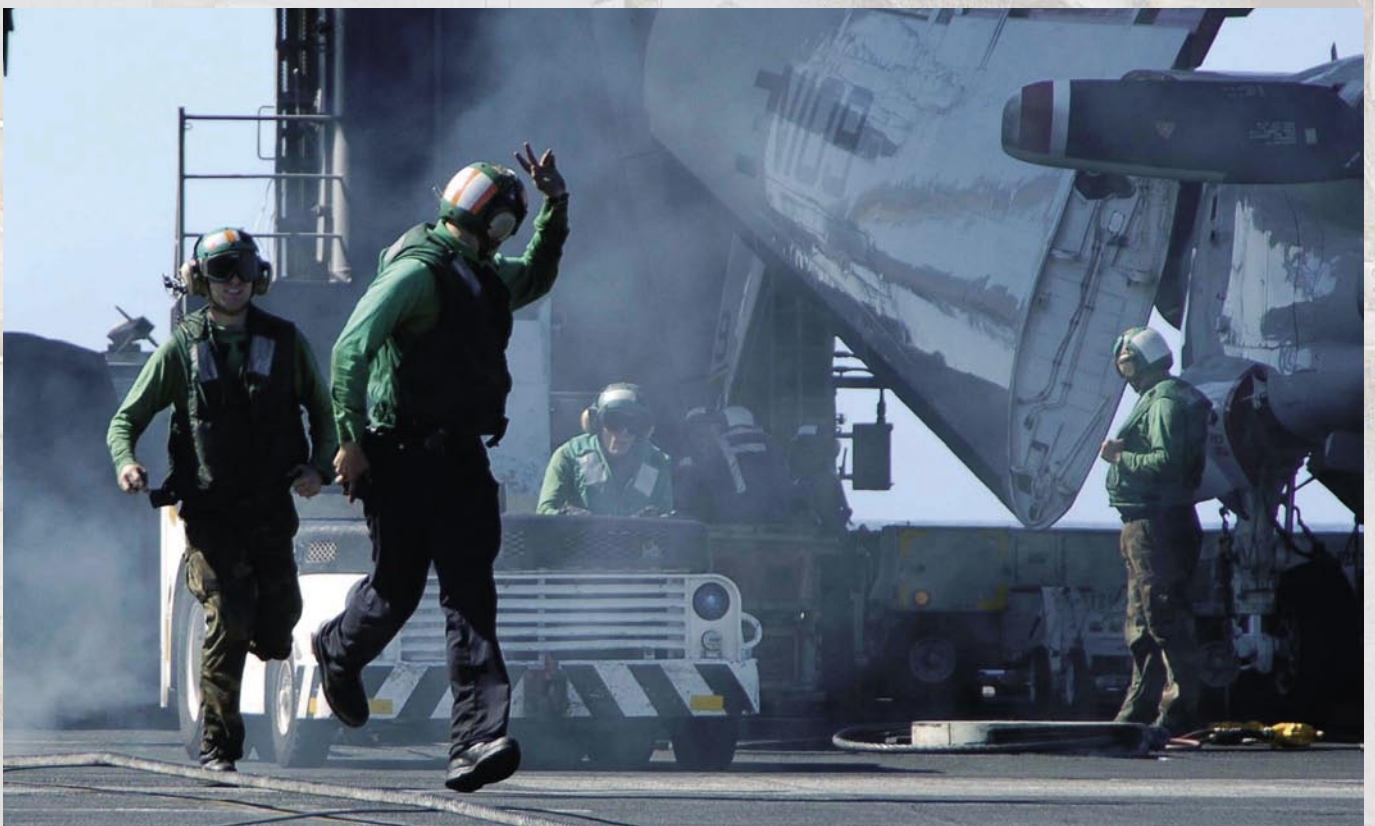
Pazifischer Ozean, 18. November 2004. Flugdeckpersonal leitet einen A/S32A-31A um das Fangnetz für eine simulierte Notlandung an Bord der USS Abraham Lincoln (CVN 72) aufzurichten.
