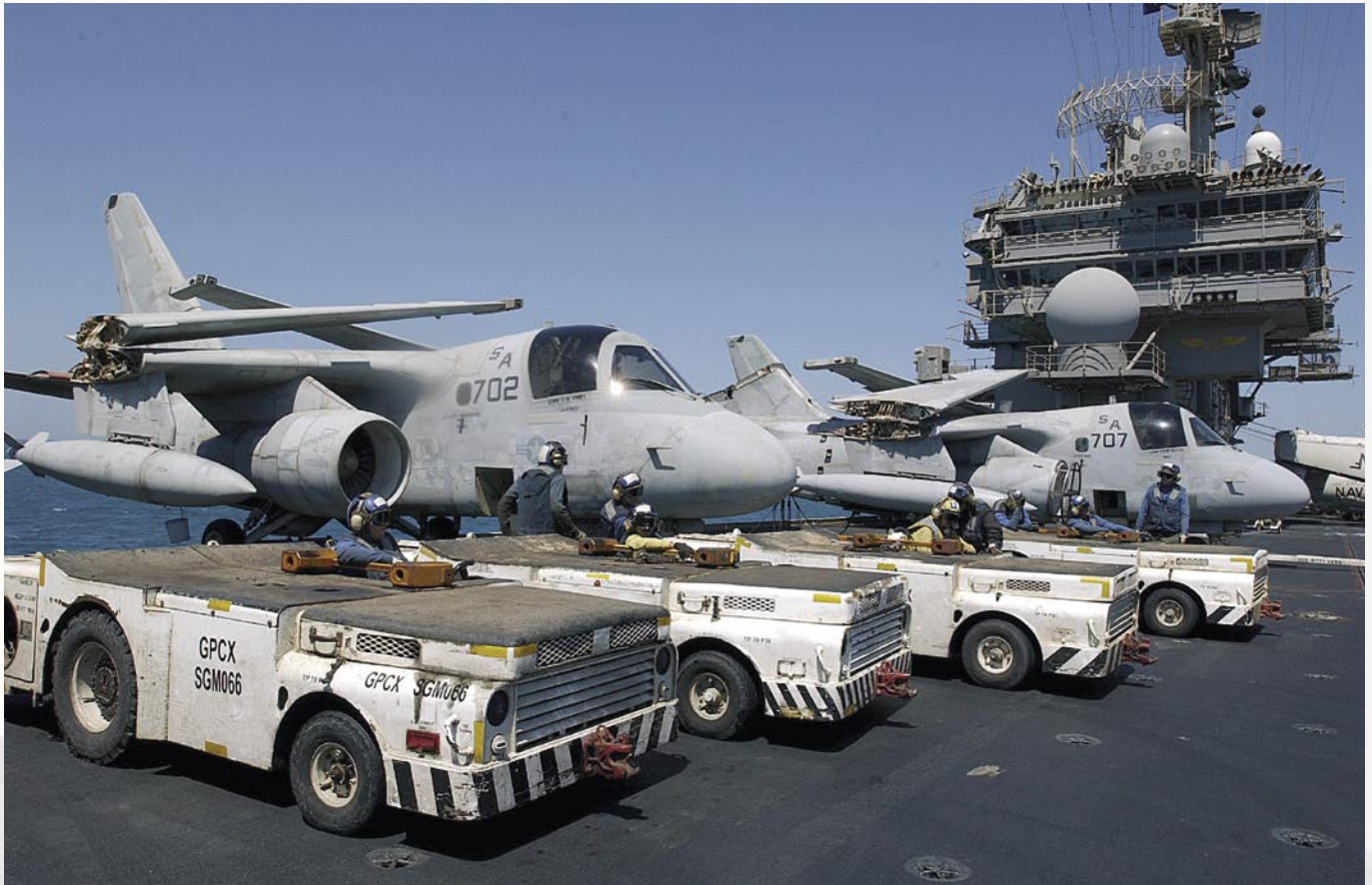
Im Arabischen Golf am 28. März 2003. A/S32A-31A Flugzeugträger-Deckszugmaschinen aufgereiht auf der Steuerbordseite am Ende der Tagesschicht auf der USS Kitty Hawk (CV 63). Alle Zugmaschinen sind heute in Weiß gehalten, während noch vor wenigen Jahre alle in Gelb gestrichen wurden. The Arabian Gulf (Mar. 28, 2003). A/S32A-31A tow tractors are positioned on the starboard side of the flight deck in preparation for aircraft movement after the conclusion of daily flight operations aboard the aircraft carrier USS Kitty Hawk (CV 63). Today all tow tractors wear white livery. Just a few years ago they all carried yellow colour. (U.S. Navy photo by Photographer's Mate 3rd Class Todd Frantom)
